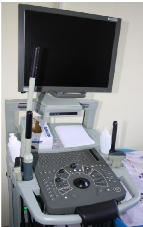
Рисунок 5. Ультразвуковой аппарат Profocus фирмы BK-medical (США) с мультимодальным бипланарным датчиком частотой 12 МГц
