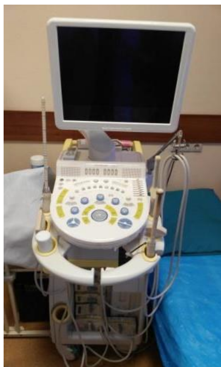
Рисунок 1. Аппарат ультразвуковой диагностики Hitachi, HI Visor Premium 2011г. в комплектации с датчиком EUR-R45A-33 (s/n KE11807101).
