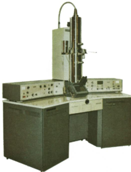
Рис. 15. Фотография просвечивающего электронного микроскопа Tesla B 560C (Чехия)
