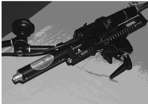
**Рис. 3.** Устройство для контролируемого движения полостных датчиков, смонтированное на фиксаторе, с датчиком 1850
